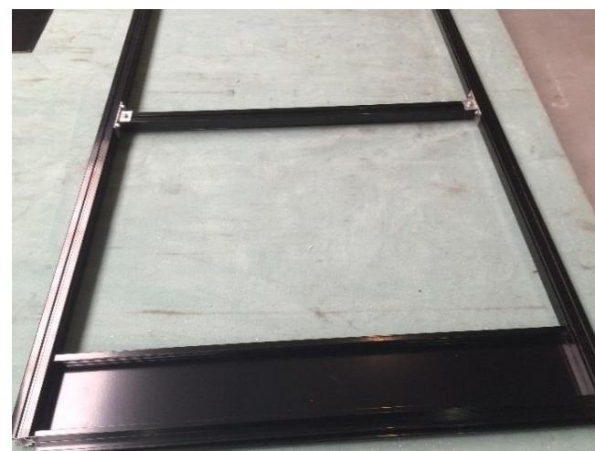
Plaats de plaat onder de dwarsligger, duw de dwarsligger tegen de plaat en span alle moeren aan.
